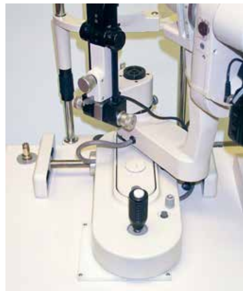
Εικ. 1.3 Το μηχανικό σύστημα ενός βιομικροσκοπίου σχισμοειδούς λυχνίας.
