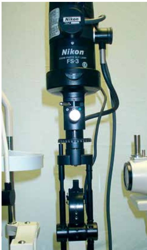
Εικ. 1.4 Σύστημα φωτισμού σχισμοειδούς λυχνίας.
