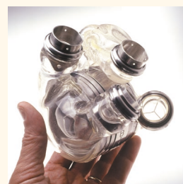
Η κλειστή τεχνητή καρδιά Abiomed, η οποία εμφυτεύτηκε για πρώτη φορά στις 2 Ιουλίου 2001. Το εξωτερικό περίβλημα είναι πολυκαρβονικό, ενώ οι βαλβίδες και η εσωτερική κοιλία είναι από πολυουρεθάνη.
